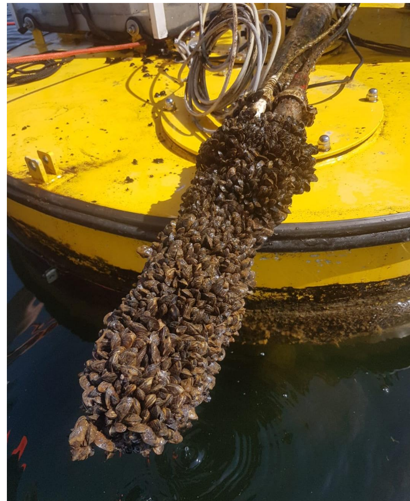
Quaggamuschel an Messsonde in der Möhnetalsperre
